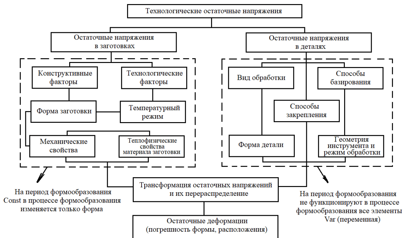
Рис. 1. Схема формирования погрешностей обработки от остаточных напряжений
